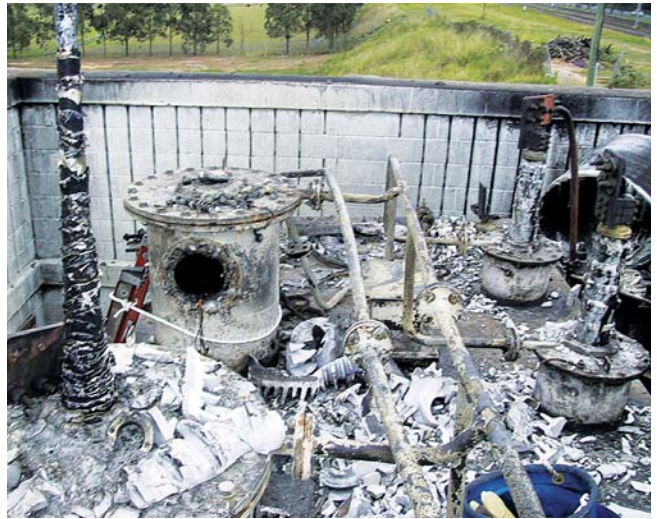
Отказ ввода с бумажно-масляной изоляцией привёл к возгоранию трансформатора 80 МВА. К счастью, пожар был локализован внутри шумозащитного экрана.
