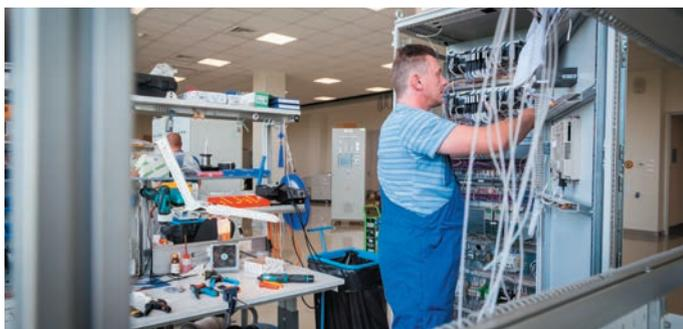
Сборочное производство «Ракурса» осуществляет монтаж низковольтных комплектующих устройств (НКУ) всех типов, спроектированных как самой компанией, так и любыми сторонними организациями. На 500 кв.м. размещены участки механической резки, монтажа и наладки.
