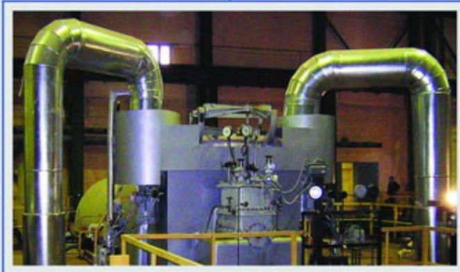
**Гидравлическая часть (ГЧСРиЗ)** (разработана ЗАО «Уральский турбинный завод») предназначена для перемещения рабочих органов регулирующих клапанов и регулирующих диафрагм с помощью сервомоторов. Автосатворы стопорных и защитных клапанов управляются давлением масла, поступающего от троированного блока золотников защит.
